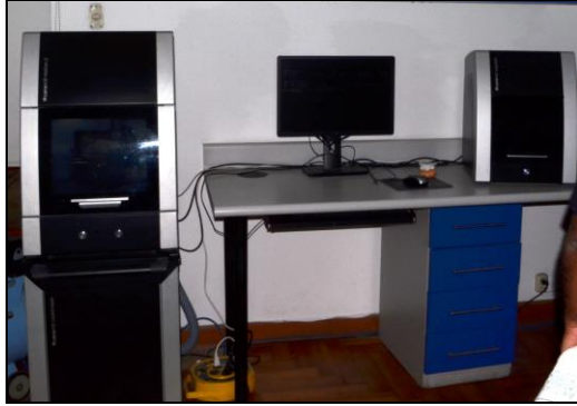
Figura 12. Ambiente de trabajo del sistema Cad-Cam, lado derecho se observa el sistema de escaneo Ceramill® Map 400 y al lado izquierdo la máquina de fresado Ceramill ®motion 2.
