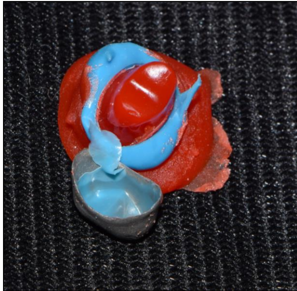
Figura 22. Silicona de adición fluida y un acrílico de combustión completa, se observa el desgarro del material.
