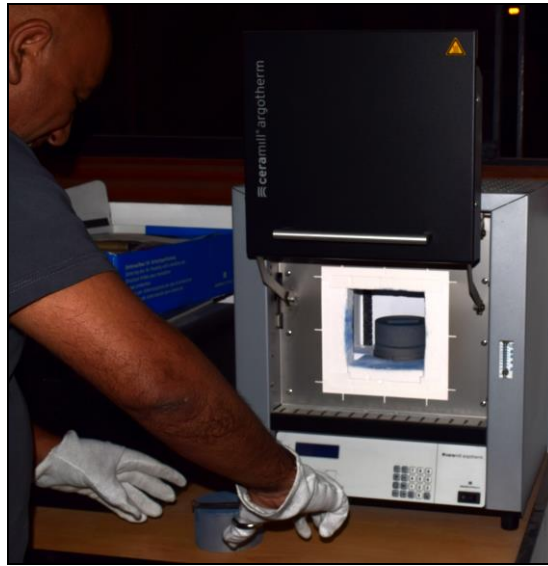
Figura 16. Ubicación de la bandeja dentro de la máquina de sinterizado Ceramill® Argotherm, para su proceso de sinterizado por un periodo 5 horas a una temperatura de 1280 °C, finalizar este proceso hay una contracción de 11%, dato brindado por el fabricante.
