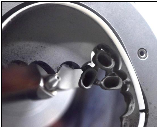
Figura 14. Tallado/fresado de los bloques pre sinterizados de aleación Co-Cr. Figura 15. Cofias de Co-Cr pre sinterizadas ubicadas en la bandeja de para su proceso de sinterización
