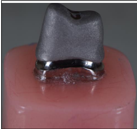
Figura 17. Evaluación visual de la falta de asentamiento de la cofia de 10 \mu m a nivel cervical y de 50 \mu m interna.
