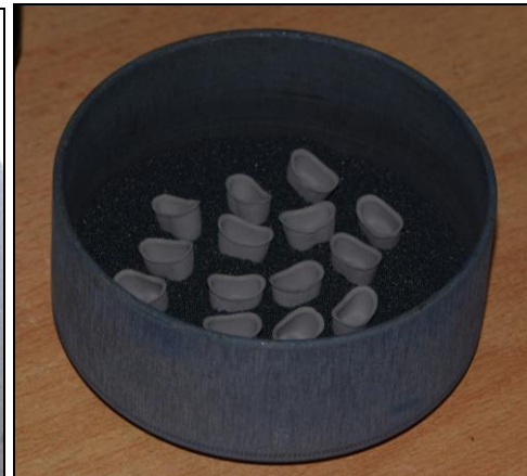
Figura 14. Tallado/fresado de los bloques pre sinterizados de aleación Co-Cr. Figura 15. Cofias de Co-Cr pre sinterizadas ubicadas en la bandeja de para su proceso de sinterización
