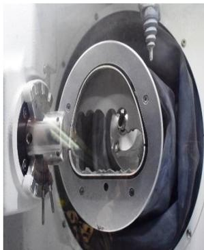
**Figura 5 :** Fresado en seco en CAD/CAM
