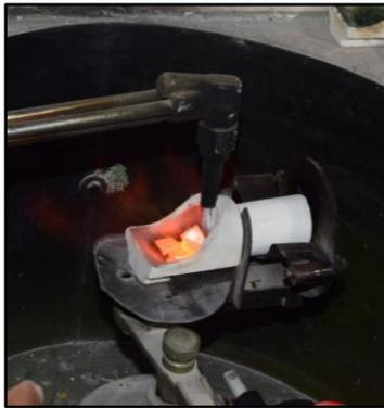
**Figura 14** : Fundición de la aleación Co-Cr
