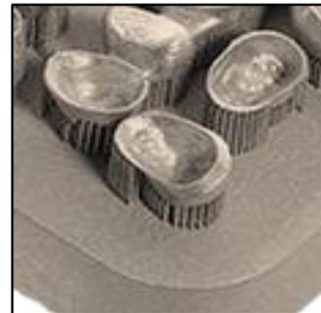
**Figura 19** : Obtención de cofias metálicas con el sistema de fusión selectiva por láser
