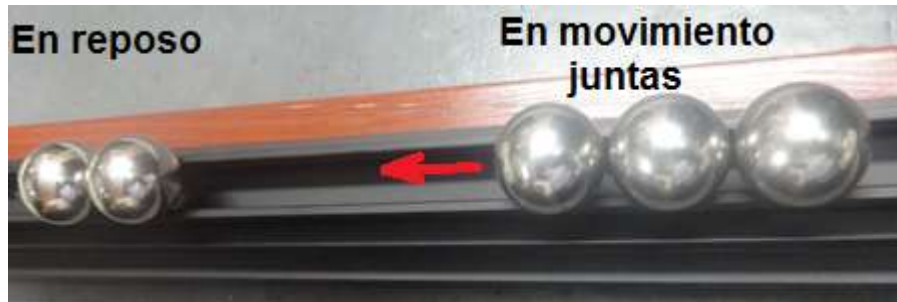
Figura 14 Impacto de tres esferas sobre dos esferas en reposo
