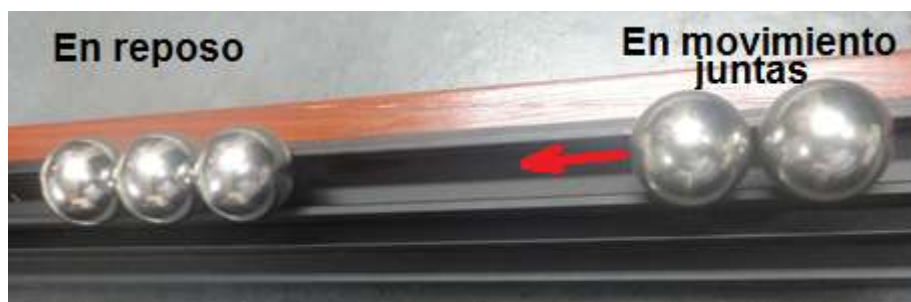
Figura 13. Dos esferas del lado derecho impacta sobre tres esferas en reposo
