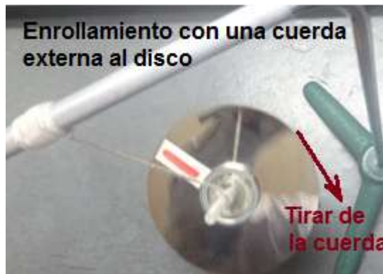
Figura 20. Enrollamiento del disco con una cuerda.
