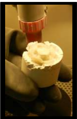
Fig. 7. Eliminación del revestimiento a 4 Bar.
