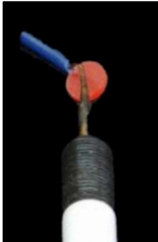
Fig 1. Colocación del jito de cera.
