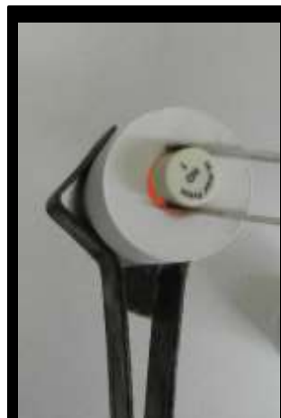
Fig. 5. Colocación de la pastilla en cilindro de revestimiento.
