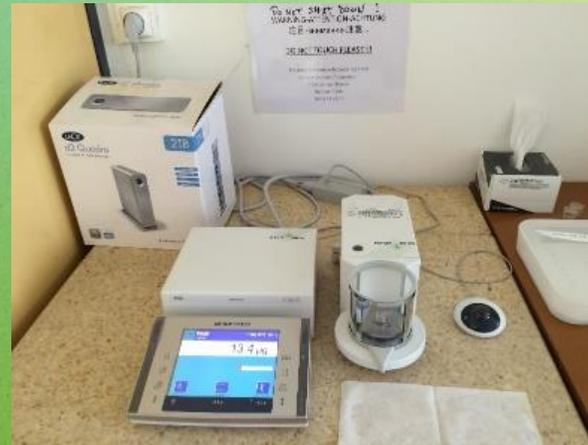
Ultramicrobalanza (precisión 0.1  $\mu\text{g}$ )
