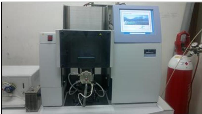
**Figura 40.** Espectrofotómetro de Absorción Atómica Perkin Elmer AAnalyst 200.
