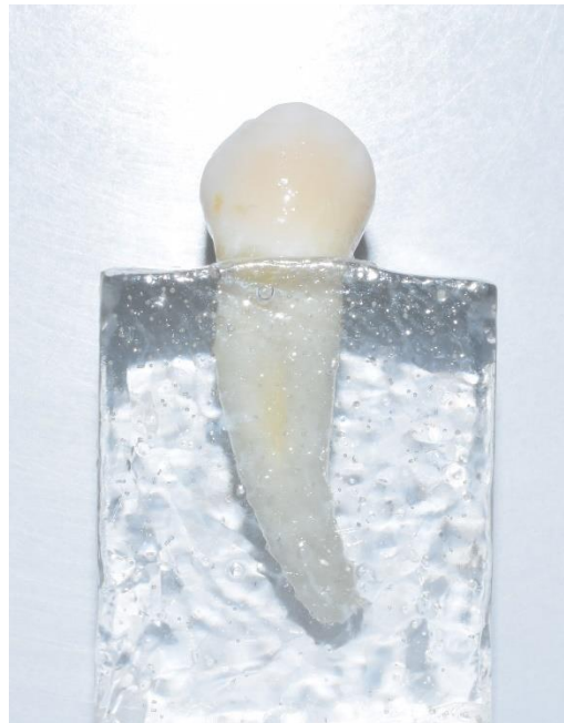
Fig. 6. Confección de cubo de acrílico (24x17x17)
