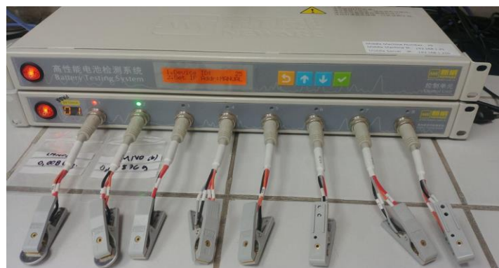
Figura 12. Medición de carga y descarga de una celda tipo moneda con un probador de batería.
