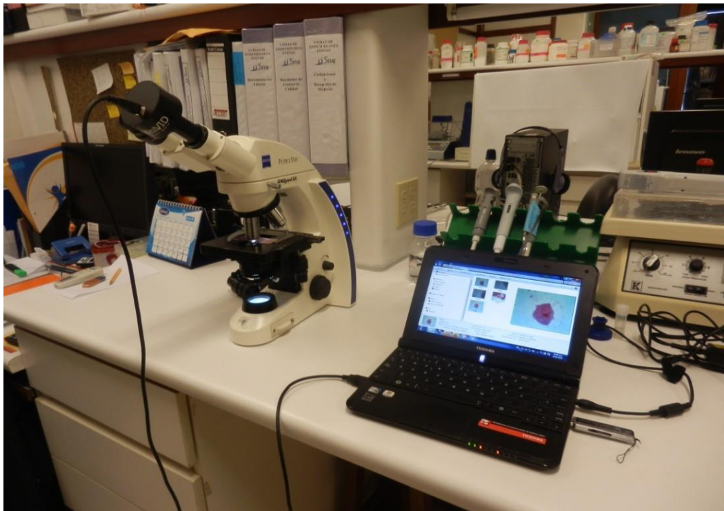
Figura 5. Sistema de digitalización de láminas de hisopados vaginales.
