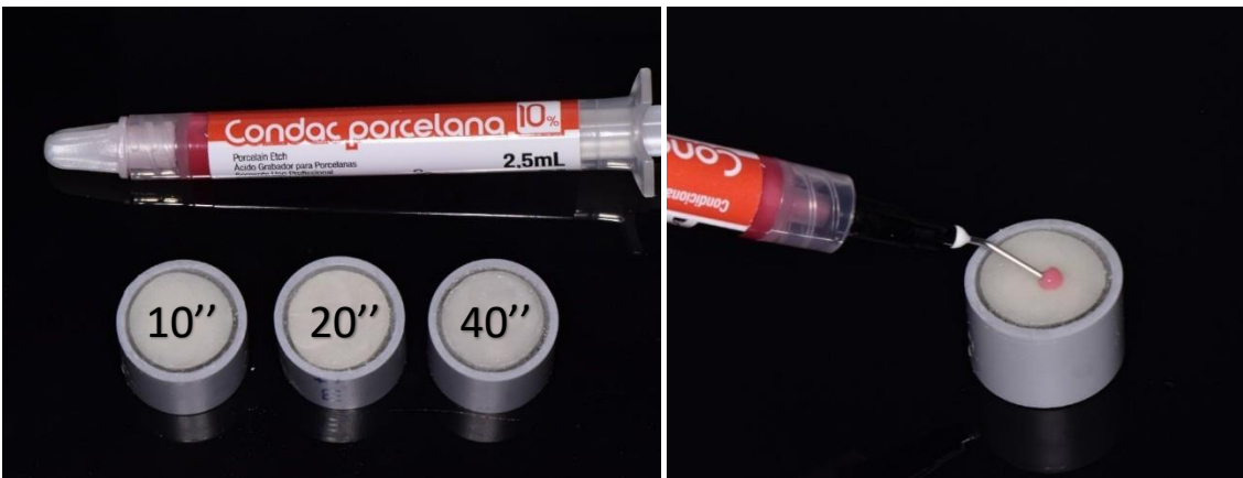
Grabado con \text{ác. HF} al 10% por 10, 20 y 40 segundos según corresponda el grupo
