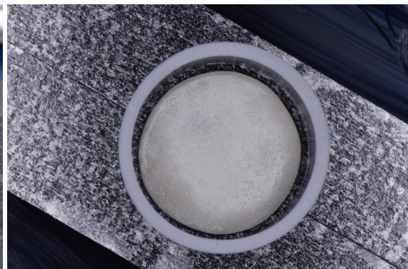
Posicionamiento del tubo de PVC, en el interior el disco que será fijado a través de un acrílico
