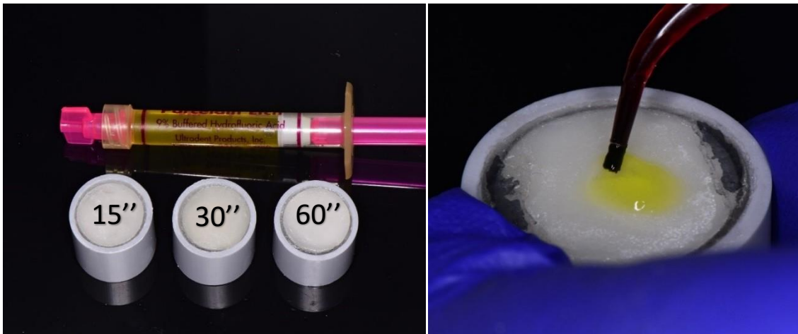
Grabado con \text{ác. HF} al 9% por 15, 30 y 60 segundos según corresponda el grupo
