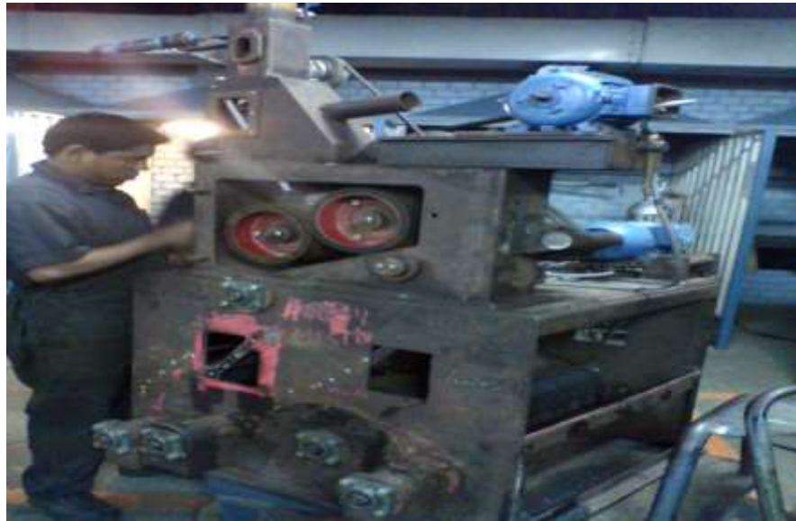
Figura 14. Ensamblado de las partes de la máquina descascaradora Fuente: Elaboración propia
