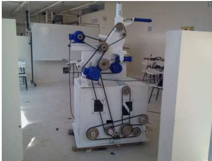
Figura 18. Ajustando los visores de la descascaradora Fuente: Elaboración propia
