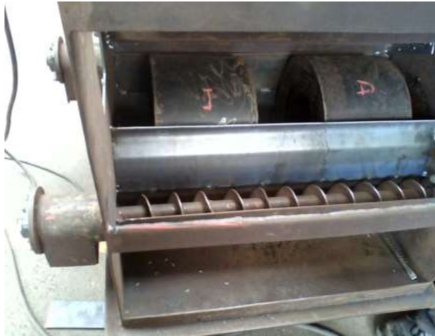
Figura 11. Armando el circuito separador de cáscara
