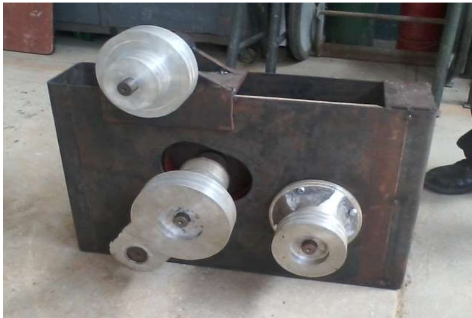
Figura 4. Ensamblando algunas poleas en la descascaradora Fuente: Elaboración propia
