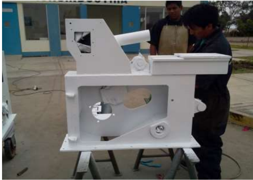
Figura 16. Pintado del cabezal de la descascaradora Fuente: Elaboración propia
