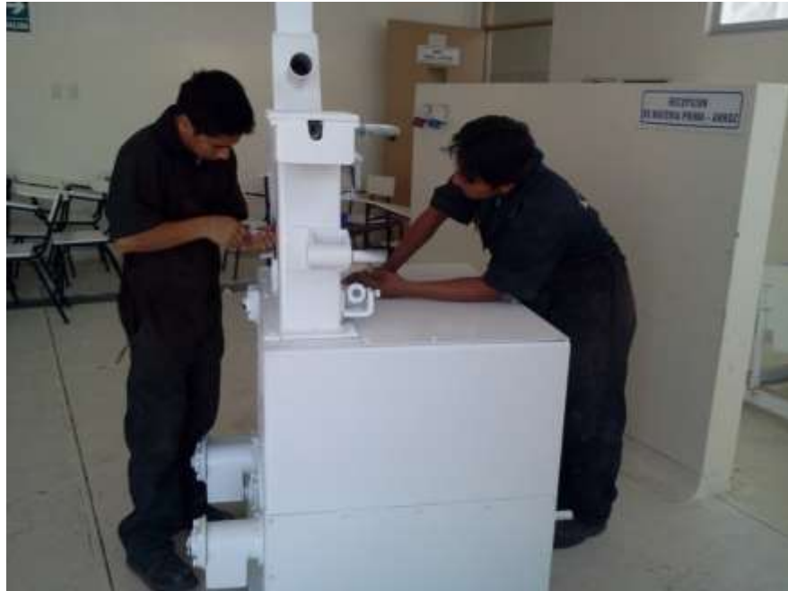
Figura 18. Ajustando los visores de la descascaradora Fuente: Elaboración propia
