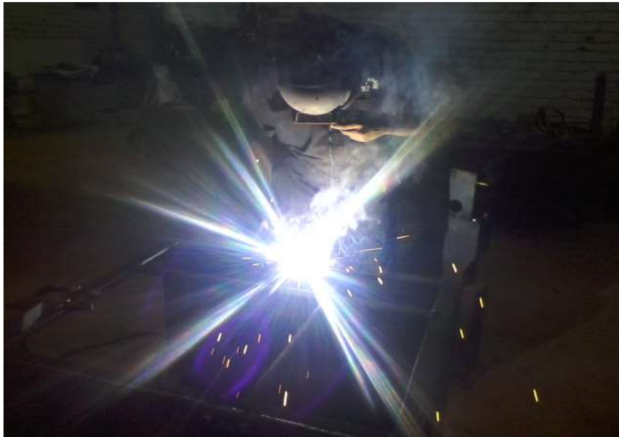
Figura 7. Soldando las partes del circuito separador de cáscara
