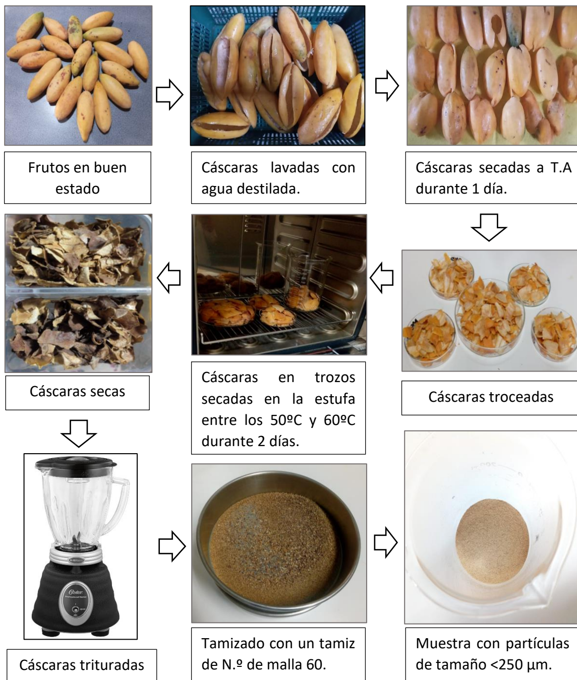
Figura 6. Obtención de la cáscara de tumbo ( Passiflora tarminiana Coppens & Barney) en polvo.
