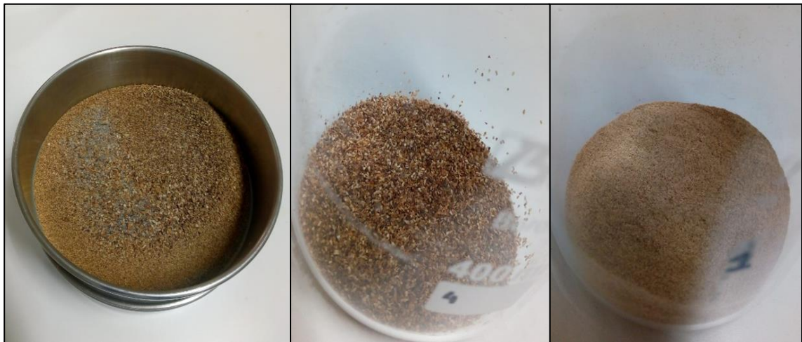
Figura 7. Al centro, masa de biosorbente acumulada y a la derecha, masa de tamaño de partículas menores a 250 \mu\text{m} con la que se trabajó en los análisis posteriores.
