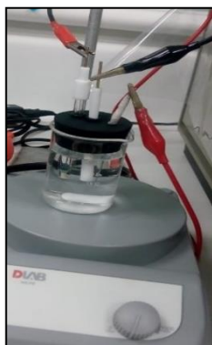
Ilustración C. Celda de 3 electrodos preparada y utilizada en los análisis de plomo (II) por Voltametría de Redisolución Anódica. Electrodo de trabajo: carbón vitreo (centro), electrodo de referencia (izquierda) y contraelectrodo alambre de platino (derecha).
