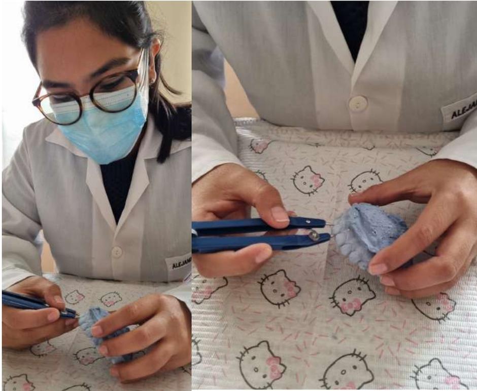
**Imagen 7:** Medición de modelo convencional vaciado en yeso.
