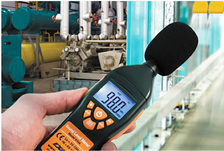
Figura 1: Medición de ruido con sonómetro (21).
