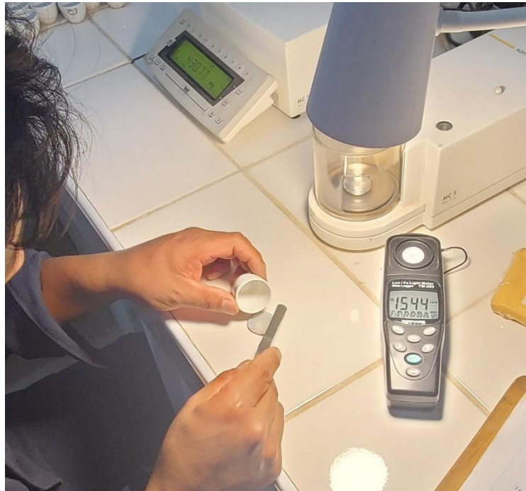
Figura 4: Medición de Iluminación con Luxómetro.
