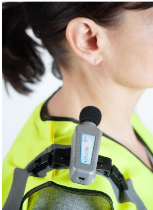
Figura 3: Medición de ruido con dosímetro (58) .
