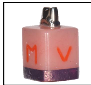
Figura 5. Modelo maestro en Co-Cr, bisel, ubicado en una base acrílica para facilitar su manipulación.
