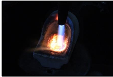
Figura18. Fundición de las pastillas Co-Cr.
