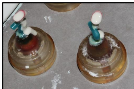
Figura 16. Patrones de cera en los conformadores siendo revestidos en yeso refractario.
