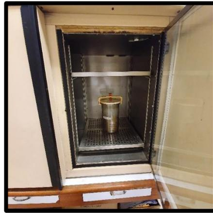
**Figura 59.-** Colocación de la cámara en la incubadora por 24 horas.
