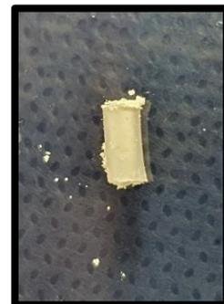
**Figura 122.-** Primer tubo de PVC lleno del CE. con adición de propóleo
