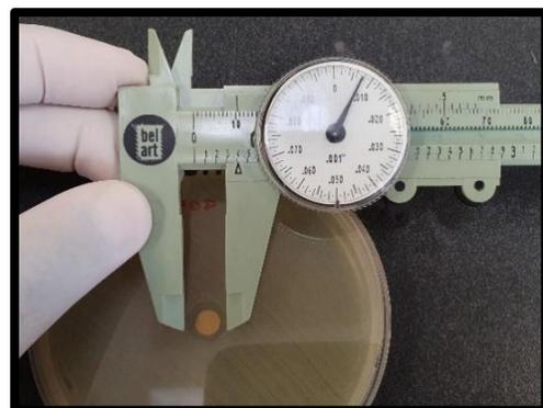
**Figura 61.-** Medición de los halos de inhibición mediante un vernier manual
