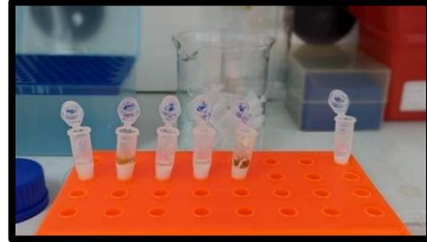
**Figura 80.-** Distribución final del CE a los mini tubos de ensayo y el reactivo
