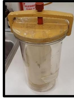
**Figura 57.-** Cámara de Anaerobiosis
