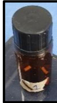
**Figura 124.-** Tubos de propileno sellados dentro del frasco
