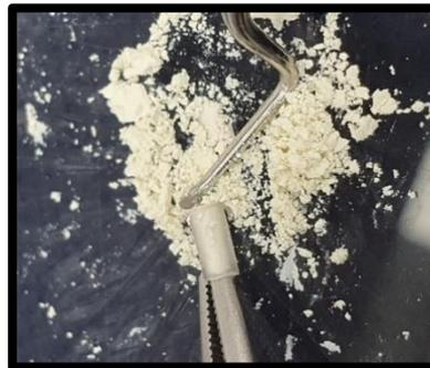
**Figura 121.-** Se colocó el material dentro del tubo de PVC con ayuda de una cureta pequeña
