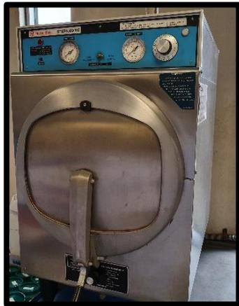
**Figura 36.-** Se cierra la autoclave y se inicia el ciclo de auto clavado
