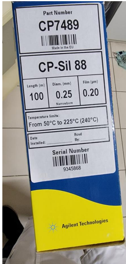
Imagen 1. Columna cromatográfica CP-Sil 88 for FAME GC Column, 100 m, 0.25 mm, 0.20 \mu m.
