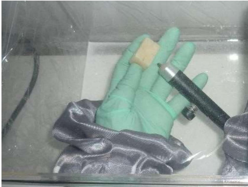
Fig. 2 Superficie arenada con óxido aluminio 50 \mu\text{m}
