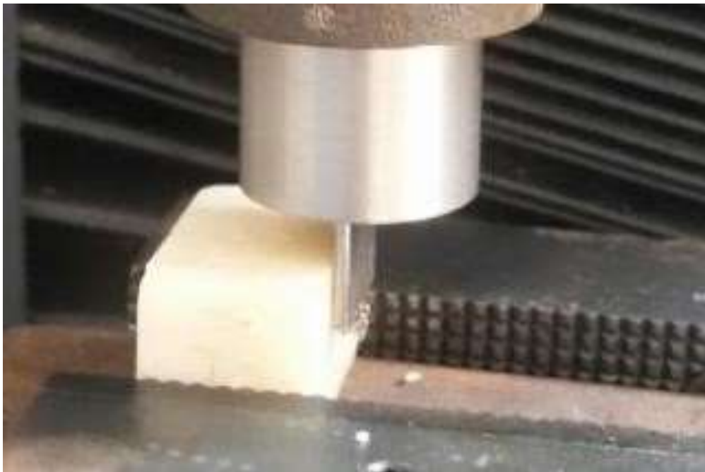
Fig. 18,19. Muestra posicionada en máquina de ensayo universal para prueba de cizallamiento.
