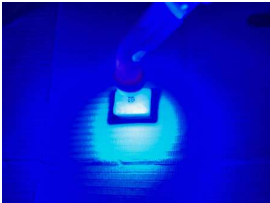
Fig. 17 La duración de la incidencia de la luz fue de 20 segundos, 10 segundos por cada lado (mesial y distal).
