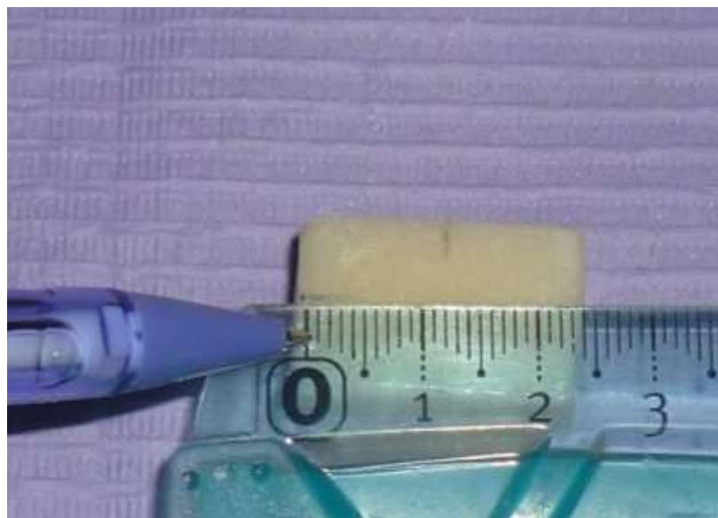
Fig. 1 Trazo en el centro de la superficie de acrílico termocurado
