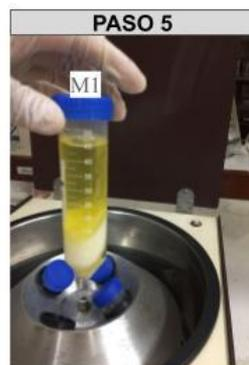
Se adicionó 3,0 g de NaCl y 3,0 g de  $\text{Na}_2\text{SO}_4$ , se mezcló vigorosamente y se centrifugó (3500 RPM, 20 min,  $T=10^\circ\text{C}$ )
