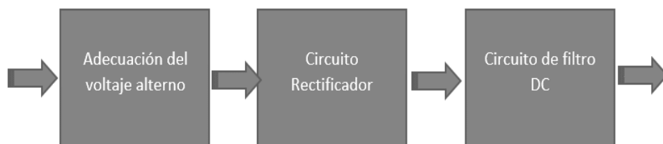
Figura 1. Diagrama de bloques de fuente de alimentación no regulada
