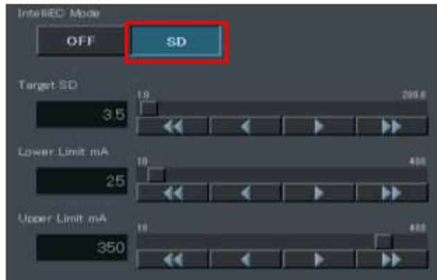
**Figura 9.** Modulador de dosis INTELLI EC del equipo de TC Hitachi.
