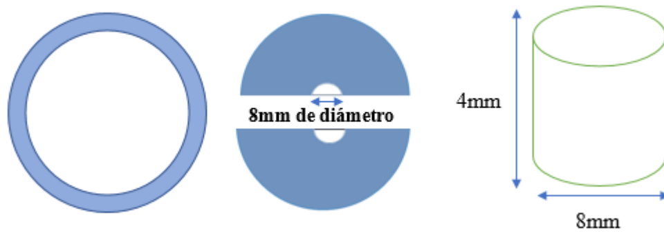
Fig 1 Diseño de matriz para resina Bulk fill (8mm de diámetro x 4mm de grosor)
