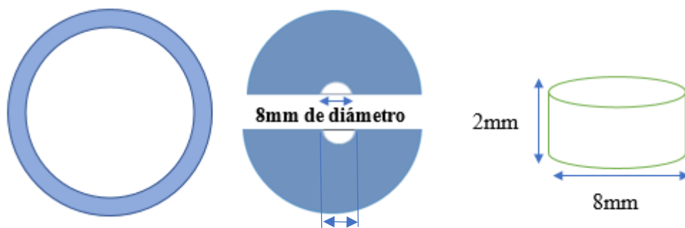
Fig 2 Diseño de matriz para resina convencional (8mm de diámetro x 2mm de grosor)
