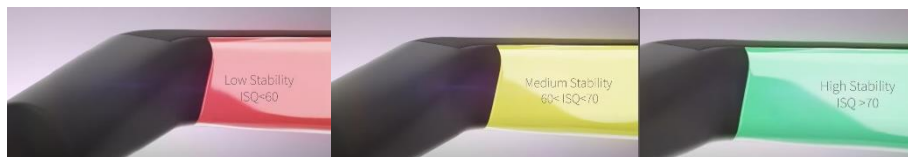
Figura 2: Valores ISQ según la escala, se muestran en el dispositivo Osstell por colores: rojo,; baja estabilidad ISQ < 60 , amarillo; mediana estabilidad 60 < ISQ < 70 ; verde, alta estabilidad ISQ > 70
