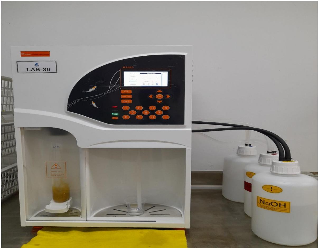
Figura A-3b. Proceso de destilación del nitrógeno Kjeldahl
