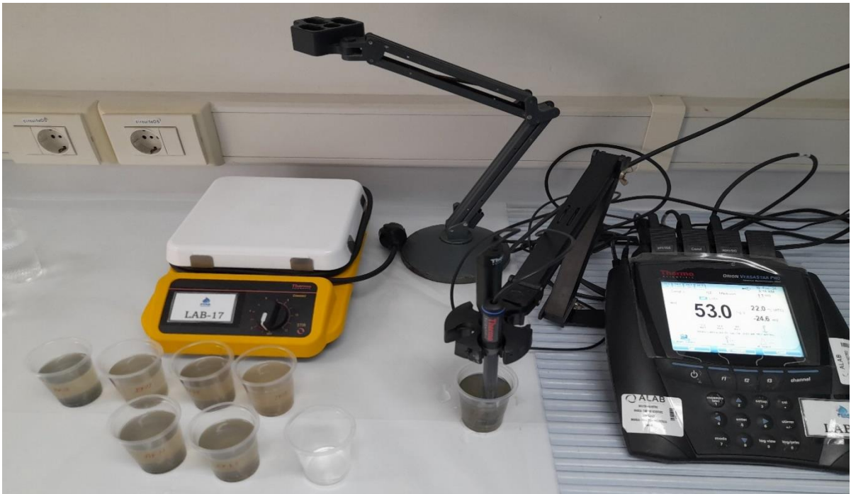
Figura A-7. Lectura de nitrógeno amoniacal mediante Electrodo de Ion Selectivo (ISE)
