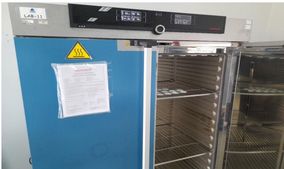
Figura A- 5a. Proceso de secado en estufa para la determinación de SST
