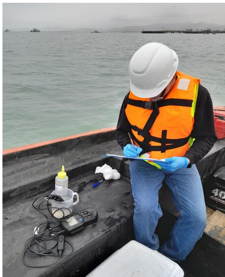
Figura A-14. Monitoreo de parámetros de campo en las estaciones de monitoreo en agua de mar
