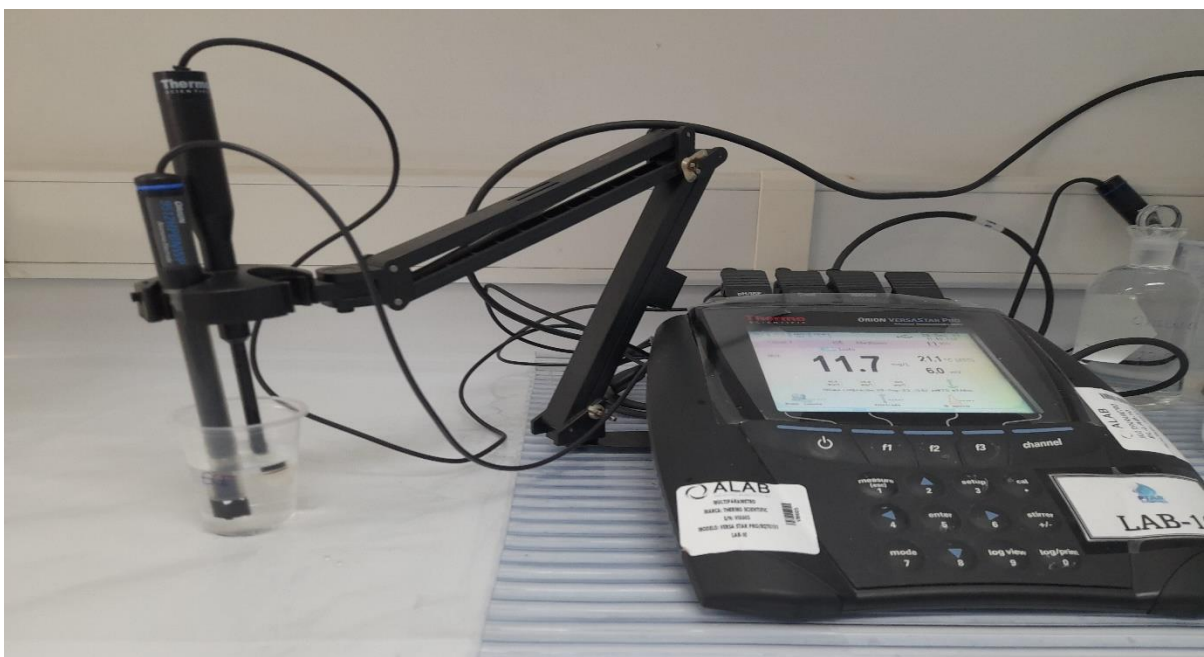
Figura A-3c. Lectura mediante el método de ion selectivo para la determinación de nitrógeno Kjeldahl
