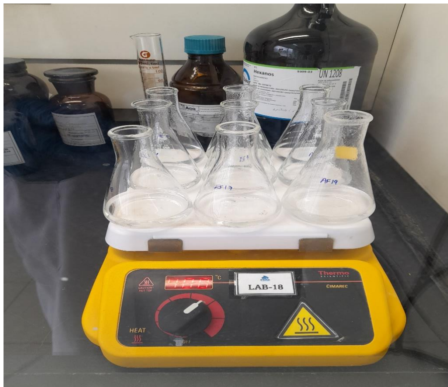
Figura A-2a. Proceso de digestión de Fósforo Total
