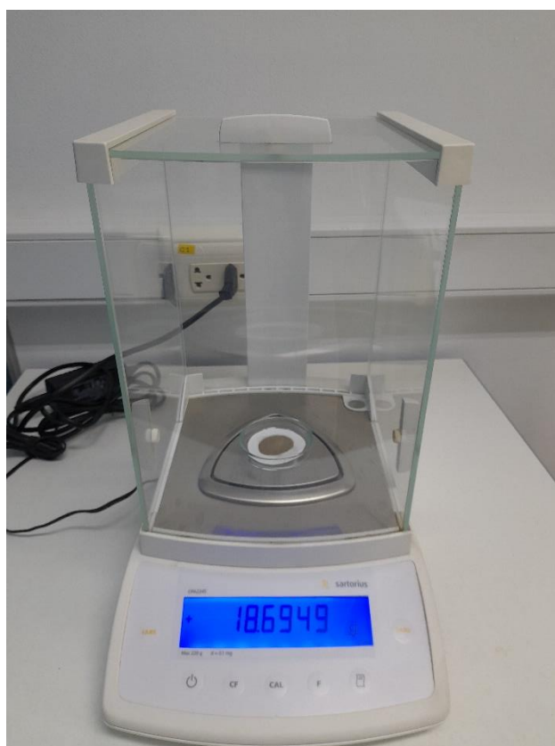
Figura A- 5b. Proceso de pesaje para la determinación de SST
