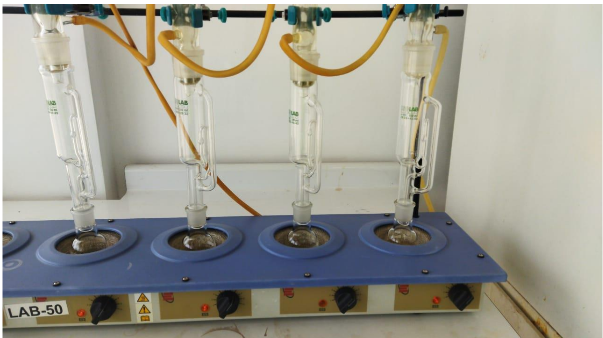
Figura A-10a. Proceso de evaporación de hexano
