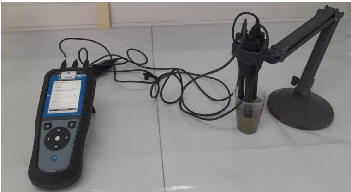
Figura A- 12. Determinación de pH, conductividad, oxígeno disuelto y temperatura con multiparámetro Hach
