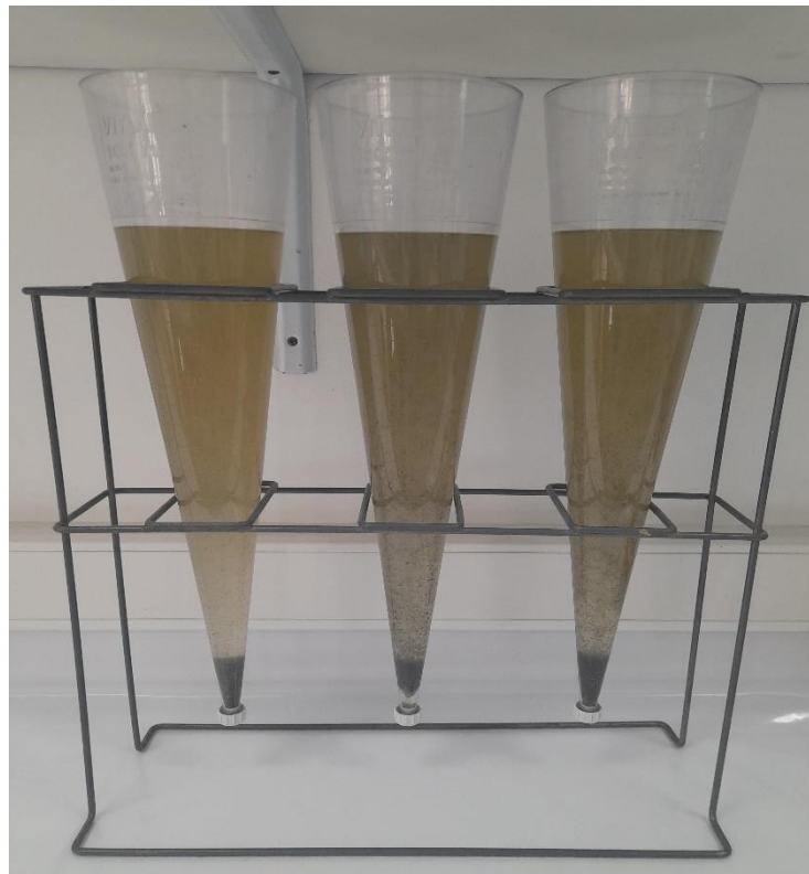
Figura A-9. Proceso de determinación de sólidos sedimentables utilizando conos Innof
