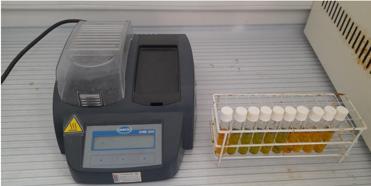
Figura A-4a. Proceso de digestión para la determinación de la DQO
