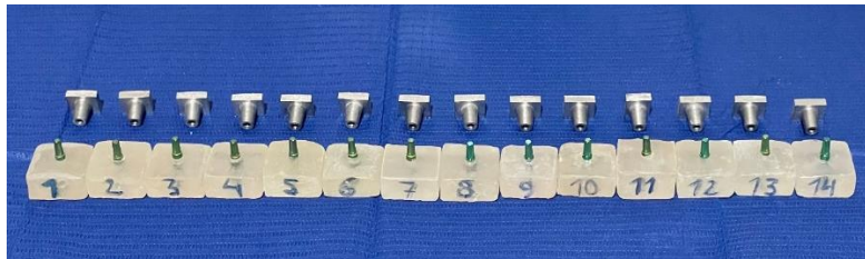
Cofias metálicas confeccionadas en fusión selectiva láser sin cementar
