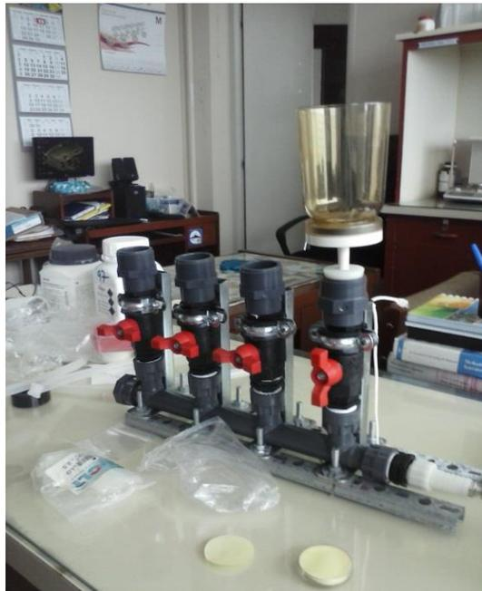
*Figura 7. Kit de filtración equipado con filtros de nitrato de celulosa (0.45  $\mu\text{m}$ )*
