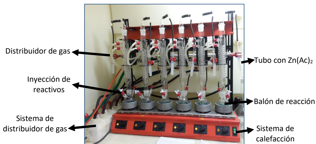
Figura 12 Sistema de destilación de AVS y CRS, puesto en funcionamiento en el laboratorio de estudios paleoambientales del departamento de geoquímica de la UFF.
