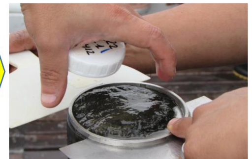
Figura 8 Extracción de variables sedimentarias en los primeros 20 cm de profundidad en los centímetros 1, 2, 3, 4, 5, 7, 9, 11, 15 y 20, i y ii: Se observa la extracción de agua intersticial mediante rizomas y mediciones en agua suprayacente y en iii y iv: se observa los cortes realizados en los intervalos mediante el uso de un anillo de 1 cm de espesor.
