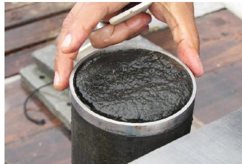
Figura 8 Extracción de variables sedimentarias en los primeros 20 cm de profundidad en los centímetros 1, 2, 3, 4, 5, 7, 9, 11, 15 y 20, i y ii: Se observa la extracción de agua intersticial mediante rizomas y mediciones en agua suprayacente y en iii y iv: se observa los cortes realizados en los intervalos mediante el uso de un anillo de 1 cm de espesor.
