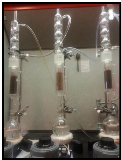
Figura 53. Acondicionamiento de las muestras por extracción Soxhlet
