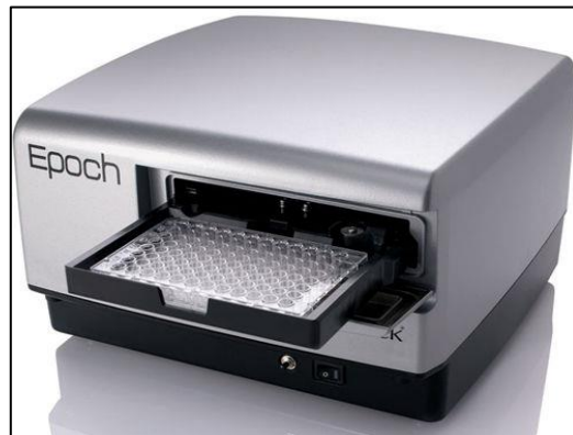
Figura 59. Espectrofotómetro UV-Visible Modelo Epoch BioTek
