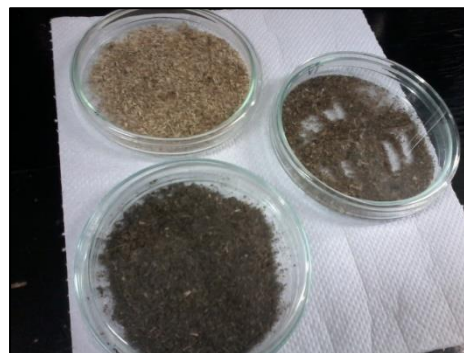
Figura 54. Adsorbentes secados a 60°C y guardados en placas de Petri
