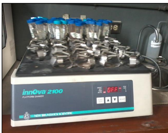
Figura 55. Muestras en el "Plataform Shaker"
