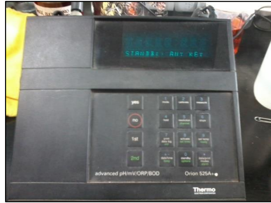
Figura 58. pH-metro Modelo Thermo Orion 525 A+
