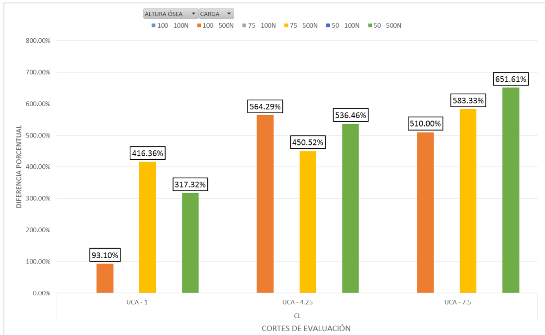
Gráfico 22. Diferencia porcentual de la concentración de esfuerzo en la pieza con LCNC, tomando a 100N como 100% en hueso alveolar.
