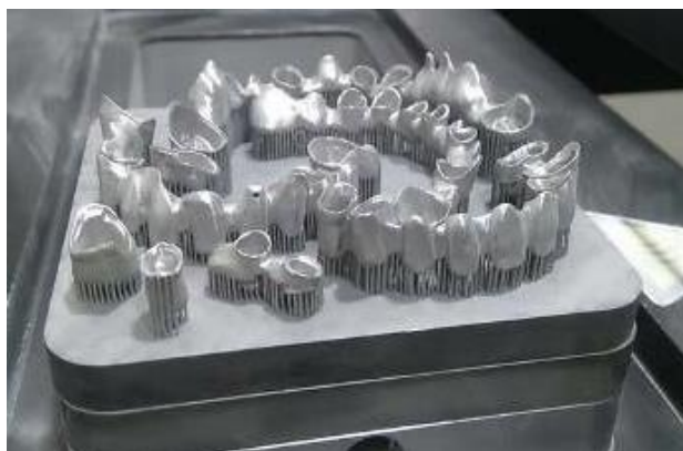
Cofias sobre la platina de fusión láser
