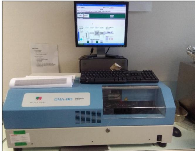
**Figura 11.** El DMA - 80 se usa para análisis de HgT en sedimentos y bentos
