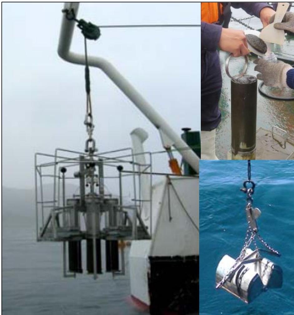
**Figura 10.** Equipos muestreadores de sedimento, MUC y draga van Veen y obtención de los primeros centímetros de sedimento.
