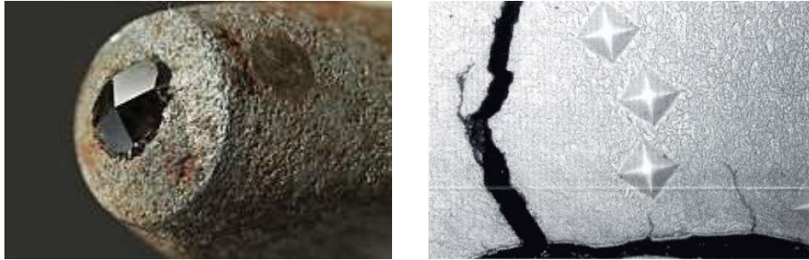
Fig 4. Microfotografía del indentador de Vickers y la impresión de este en latón 35
