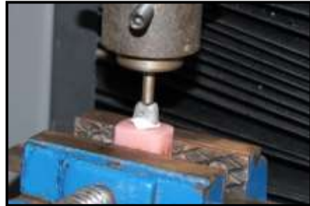
Figura 21. Aplicación de fuerza constante que simula la presión digital.
