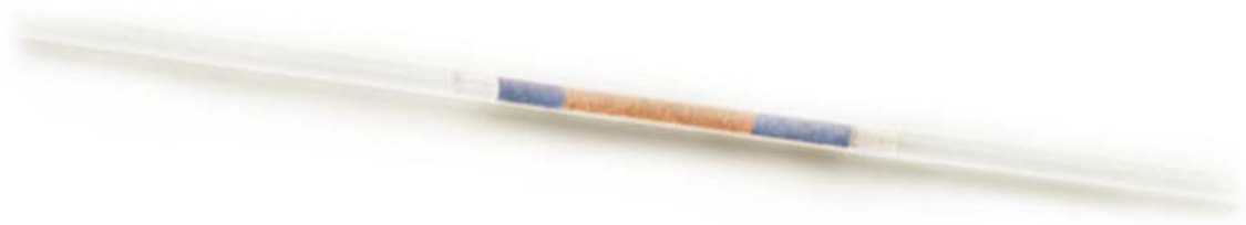
Figura 1: Tubo indicador con cambio de color positivo (18).
