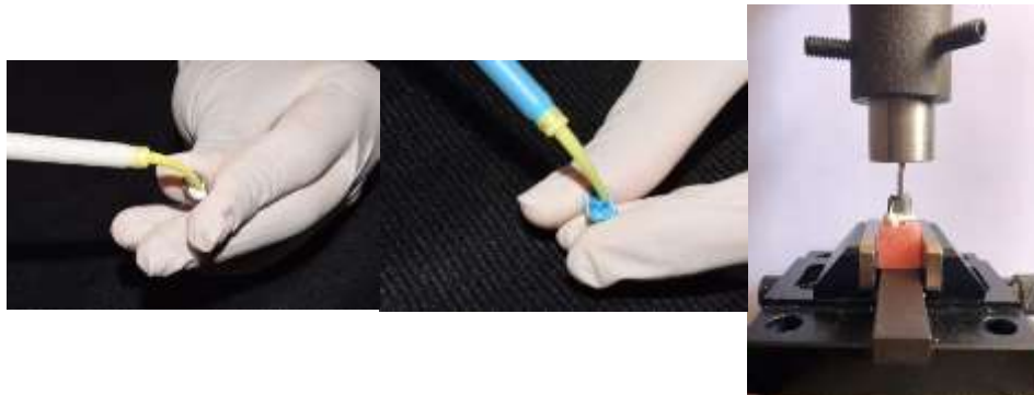
FIGURA 6. Aplicación del Fit Checker con presión constante a 50 N en la máquina Instron y obtención de la réplica de silicona
