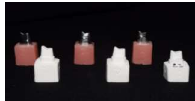
FIGURA 4. Modelos maestros en Co-Cr y modelos de trabajo en yeso tipo IV.
