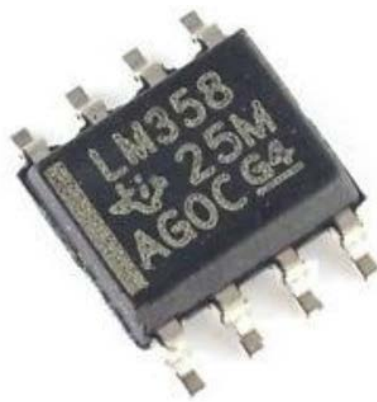
Figura 11. Amplificador operacional LM358
