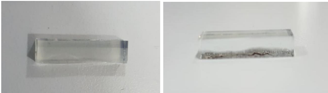
Figura 3. Vidrio FTO de dimensiones 2cm x 0.5cm sobre el cual se inmovilizará las capas que conforman al biosensor APA.
