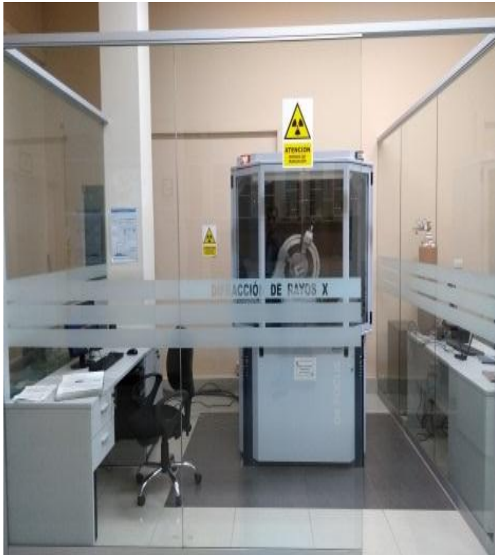
Equipo de Difracción de Rayos X (BrukerASX X-ray) para la realización del análisis químico elemental de los cementos de estudio
