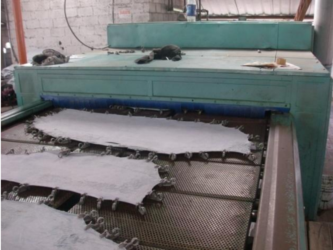
Figura 2. "Togging" usado para estirar y secar los cueros
