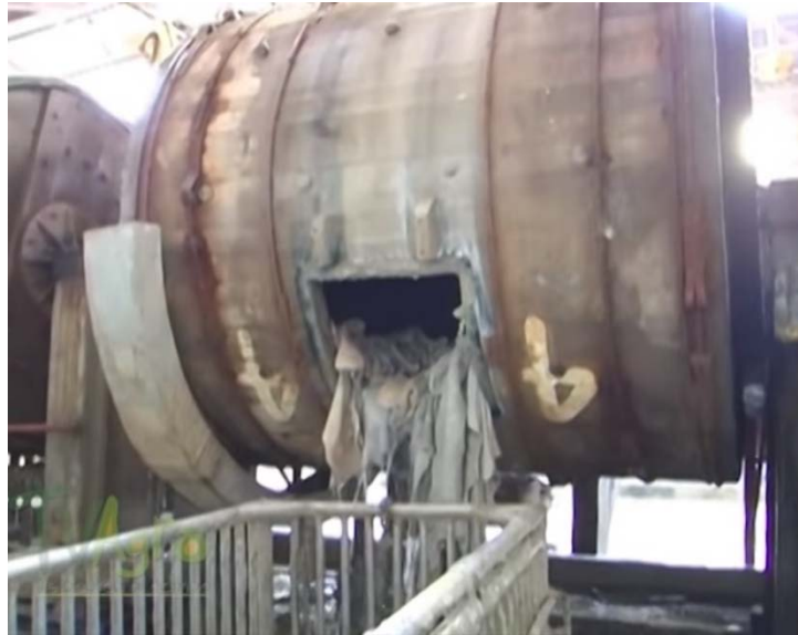
Figura1. Noque o rueda usada para el rodamiento en diferentes etapas del curtido
