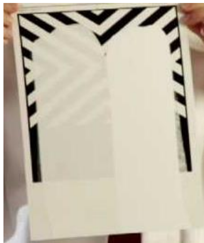
Figura 18. Ejemplo de comparación de poder cubriente entre un patrón (estirado en el lado izquierdo) y la muestra (estirado en el lado derecho)
