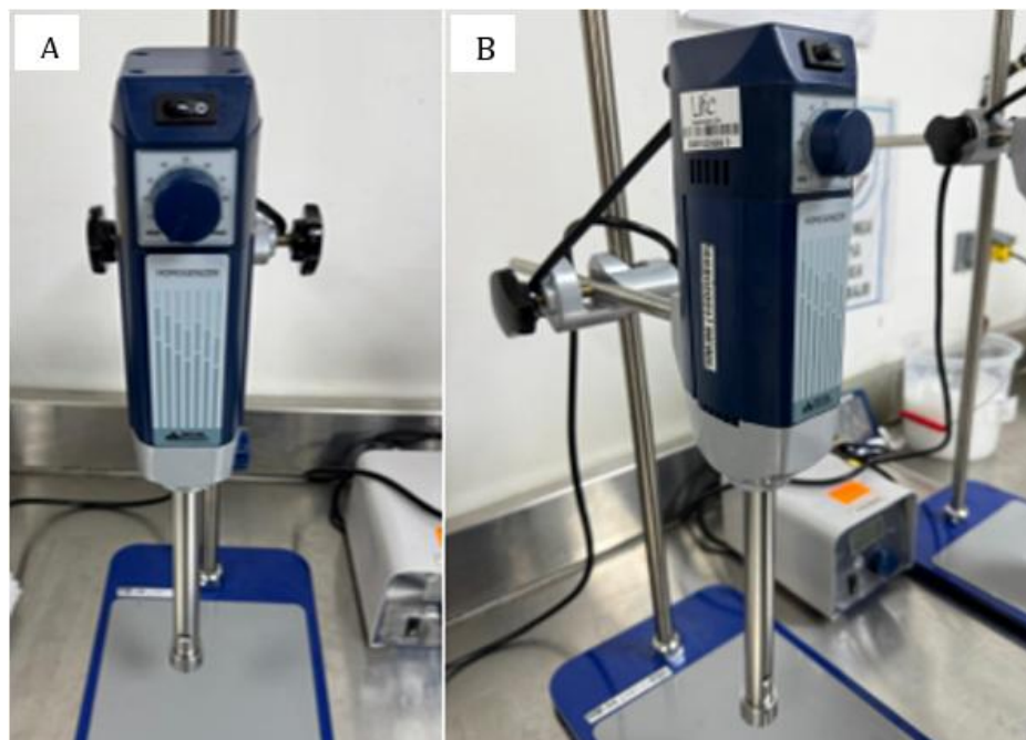
Figura 2. Homogeneizador DAIHAN Scientific HG-15D utilizado durante la preparación de los ensayos experimentales. (A) Vista frontal del equipo. (B) Vista lateral del equipo. (Fuente: Elaboración propia).
