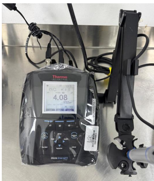
Figura 4. pH-metro Thermo Scientific Orion Star A211 utilizado para la medición de pH de las formulaciones durante los estudios de estabilidad. (Fuente: Elaboración propia).
