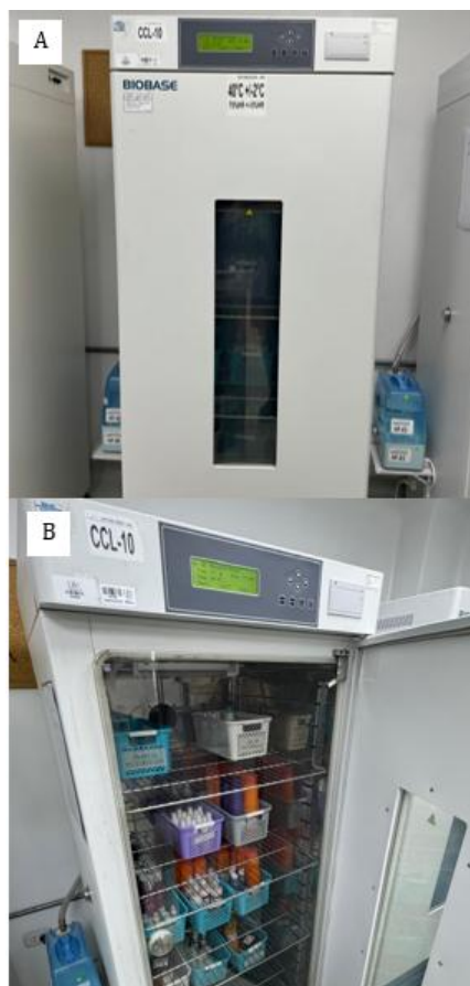
Figura 6. Cámara climática BIOBASE. Modelo: BJPX-HT40011. utilizada para el estudio de estabilidad acelerada. (A) Cámara climática BIOBASE empleada a 40 \pm 2 °C y 75 \pm
