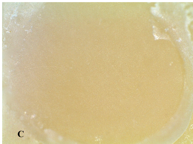
Figura 1. Vistas en microscopio estereoscópico (8.0x) de diferentes patrones de falla: A) Mixta, B) Cohesiva y C) Adhesiva.
