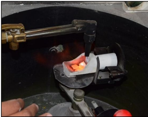
Figura 14. Calentamiento de la aleación con un soplete que mezcla gas y oxígeno, nótese la máquina centrífuga que se activa cuando la
