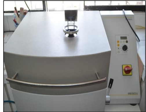
Figura 15. Máquina para colador de metales mediante la técnica de Inducción Fornax® T (BEGO® ,
