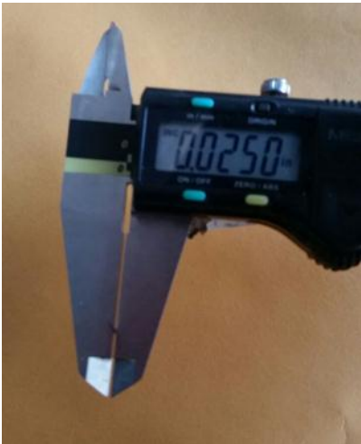
Figura 5. Verificación del diámetro del alambre de 0.017 x 0.025”.
