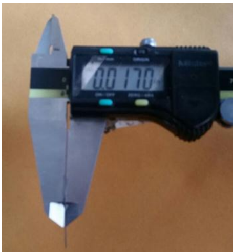
Figura 4. Verificación del diámetro del alambre de 0.017 x 0.025”.
