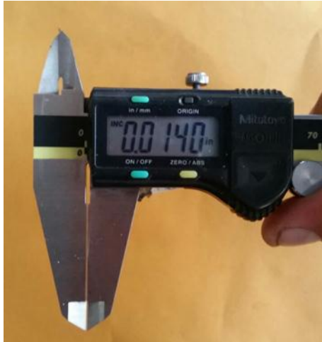
Figura 3. Verificación del diámetro del alambre de 0.014”.
