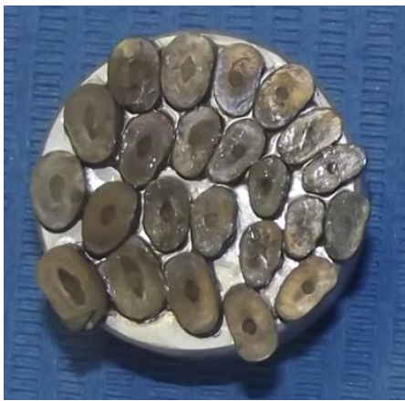
Figura 48. Colocación de especímenes en base metálica
