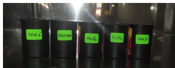
Figura 35. Almacenamiento de especímenes cementados por 24 h a 37°C
