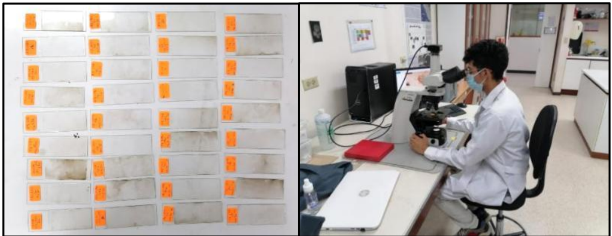
Figura 8. Láminas portaobjetos con la muestra procesada de sedimento listas y posterior conteo en el microscopio.
