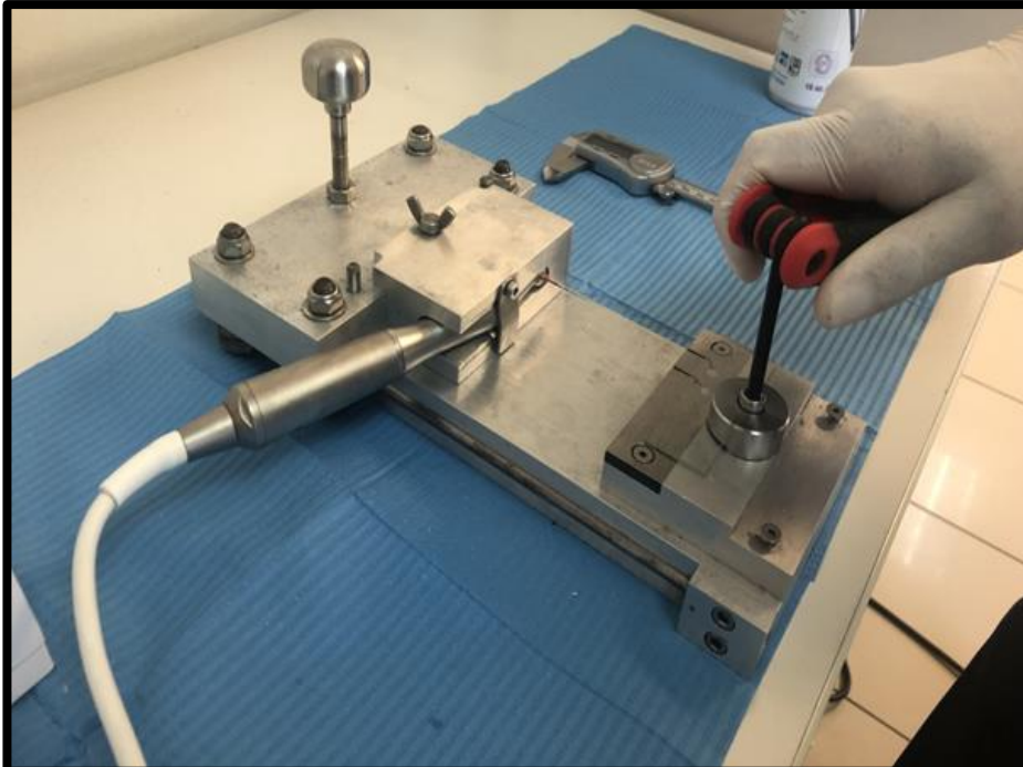
AJUSTANDO LAMINA DE VIDRIO SOBRE EL CONDUCTO ARTIFICIAL
