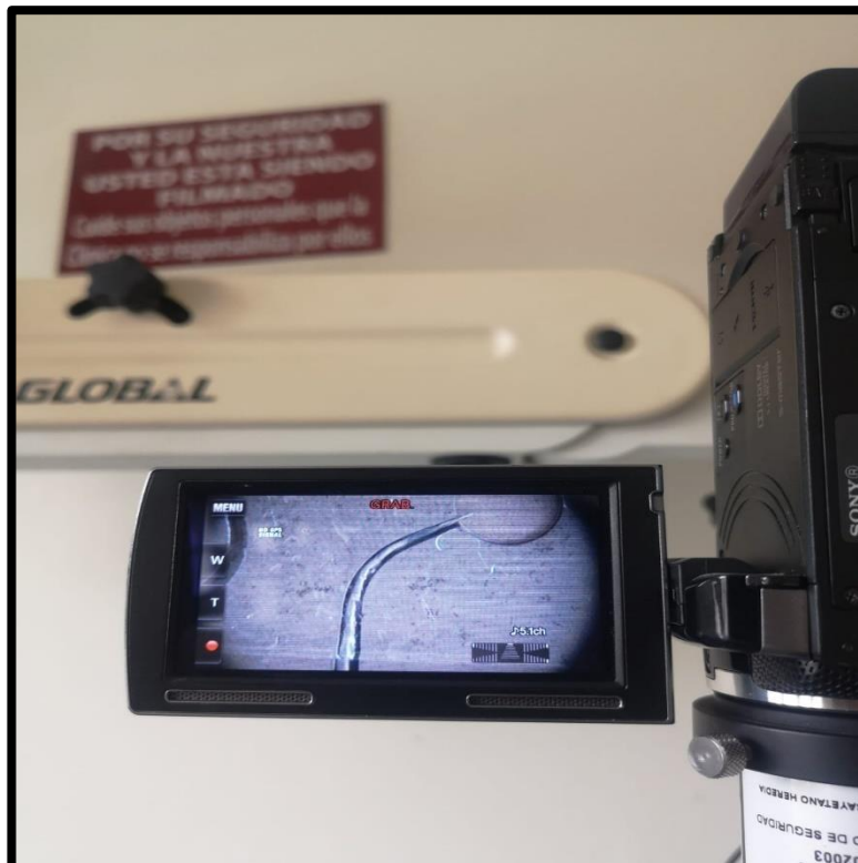
REGISTRO EN VIDEO DE LA LIMA EN MOVIMIENTO RECIPROCANTE
