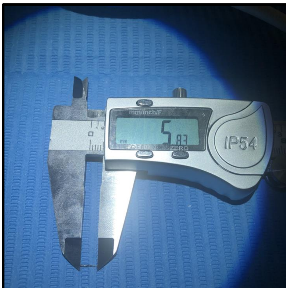
MEDICIÓN DE FRAGMENTO DE LIMA POR MEDIO DE CALIBRADOR DIGITAL
