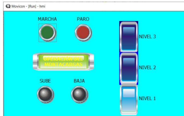
Pantalla de operación del montacargas por el HMI
