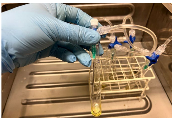
Secado de muestra en baño maria con flujo de nitrógeno
