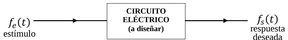
Figura 6. Síntesis de circuitos eléctricos
